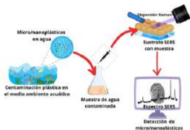
Figura 2. Metodología de la aplicación de un sustrato SERS para analizar muestras reales contaminadas con micro/nanoplasticos
