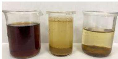
Figura 2. Proceso de Floculación-coagulación. Realizada en laboratorio
