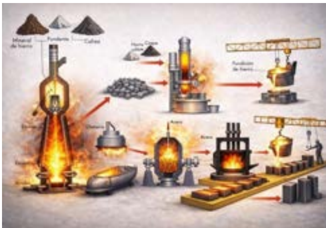
Figura 4. Diagrama esquemático de la obtención del acero y aleaciones. (Elaboración propia)
