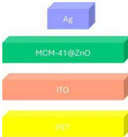
Figura 7. Representación esquemática de la estructura del dispositivo memristor usando MCM-41.
