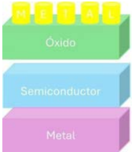
Figura 3. Representación esquemática de la estructura de un capacitor MOS. Fuente propia.
