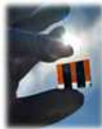
Figura 1. Celda Solar de Perovskita con contactos de Carbón obtenida en el Laboratorio de Celdas Emergentes (elaboración propia, fotografía tomada desde VAL-2, Ecomcampus Valsequillo, BUAP)
