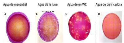
Figura 2. Resultados de la evaluación de enterobacterias y coliformes en muestras de agua de diversas fuentes mediante el sistema de placas Petrifilm (3M). (A) Agua de manantial: alta densidad de enterobacterias de origen fecal, visible como puntos rojos y cambio de color de la placa a amarillo debido a la fermentación y producción de ácido. (B) Agua de llave: crecimiento de
