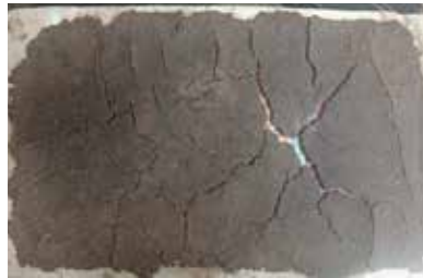
Figura 8. Placa de Lirio secada al Sol que presenta una fractura muy grande en su estructura.
