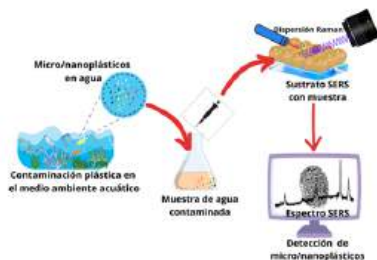
Figura 2. Metodología de la aplicación de un sustrato SERS para analizar muestras reales contaminadas con micro/nanoplásticos
