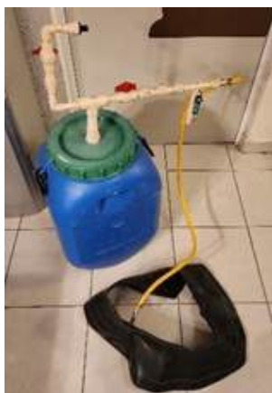
Fig. 2. Biorreactor con tuberías de transporte de biogás de CPVC conectados a depósito de almacenamiento de biogás (cámara de llanta) - Elaboración propia
