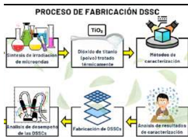
Fig.3. Proceso de fabricación de DSSCs.
