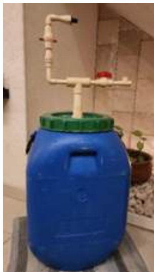
Fig. 1. Biorreactor con tuberías de transporte de biogás de CPVC - Elaboración propia
