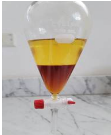
Fig 5. Transesterificación para obtener biodiésel y glicerina.
