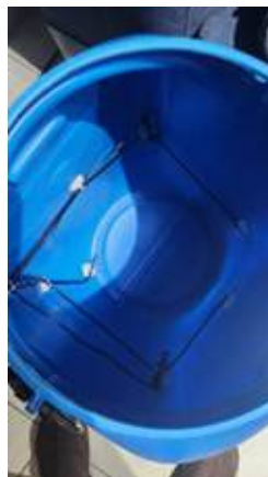
Fig. 7. Instrumentación de sensores de pH y de temperatura en biodigestor - Elaboración propia
