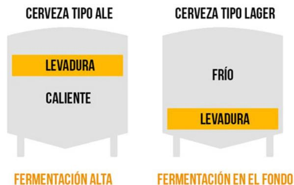
Figura 2. Posición de la levadura en la fermentación alta y baja.
