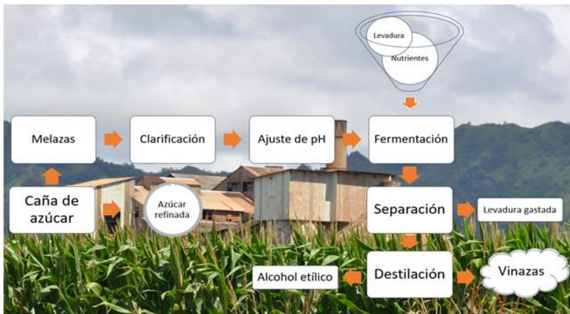
**Figura 2b. Producción de etanol a partir de las mieles finales o incristalizables o melazas de la caña de azúcar para obtener azúcar, energía limpia para los seres humanos y energía para los procesos humanos: electricidad, calor, energía mecánica, etc. (Información tomada de de-Bazúa y col., 1991 y mejorada por Contreras-Contreras, 2019)**
