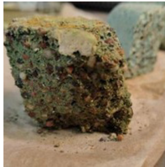
Figura 11. Muestra deteriorada por HCl
