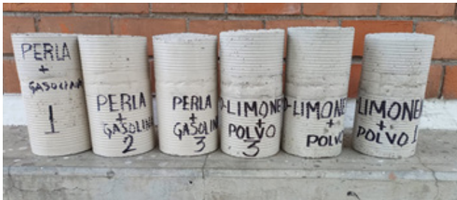
Figura 2. Identificación de probetas para prueba ASTM C39 Nota. Elaboración propia
