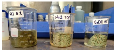
Figura 9. Ensayo de resistencia química durante 7 días
