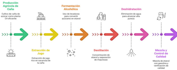
Figura 2. Etapas en la producción de etanol. Fuente: elaboración propia
