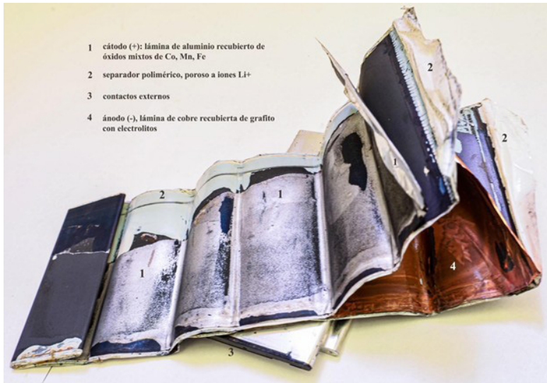
Figura 1. Componentes de una Batería de Ion-Litio y su contribución en peso. Elaboración propia.
