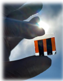
Figura 1. Celda Solar de Perovskita con contactos de Carbón obtenida en el Laboratorio de Celdas Emergentes (elaboración propia, fotografía tomada desde VAL-2, Ecocampus Valsequillo, BUAP)
