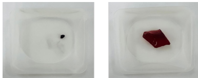
Figura 6. Representación de xerogel (izquierda) e hidrogel hinchado (derecha).
