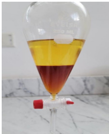
Fig 5. Transesterificación para obtener biodiesel y glicerina.
