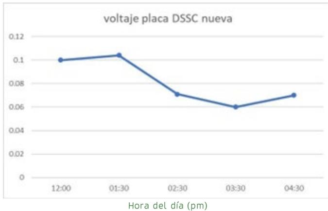
Figura 6. Gráfica de voltaje contra la hora de medición.
