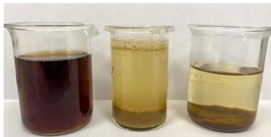
Figura 2. Proceso de Floculación-coagulación. Realizada en laboratorio
