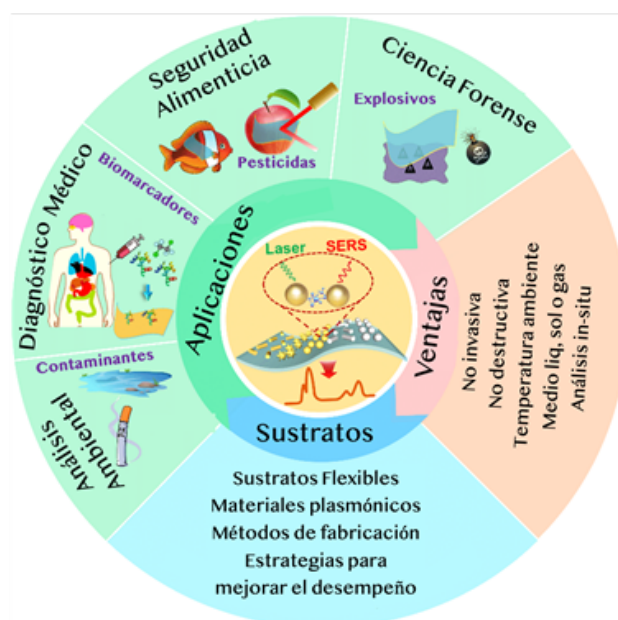
Figura 5. Gráfico esquemático que muestra la fabricación de sustratos, ventajas y aplicaciones de SERS (Xie et al., 2022).
