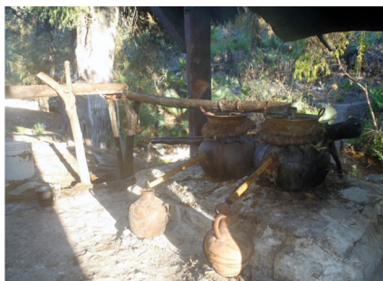
Figura 18. Canaletas sostenidas por horcones por donde corre el agua para enfriar la montera de los destiladores. Santa María Ixcatlán, Oaxaca. Fotografía: Víctor Hugo Romero Aranda.
