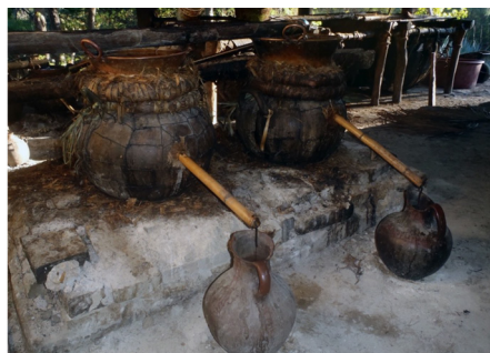
Figura 13. Ollas de barro usadas como destiladores. Santa María Ixcatlán, Oaxaca. Fotografía: Víctor Hugo Romero Aranda.
