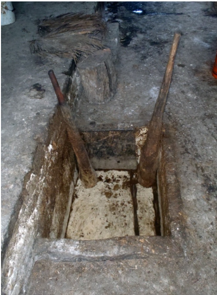
Figura 9. Mazos de madera y canoa para moler los trozos de maguey cocido. Santa María Ixcatlán, Oaxaca. Fotografía: Víctor Hugo Romero Aranda.
