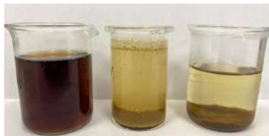
Figura 2. Proceso de Floculación-coagulación. Realizada en laboratorio
