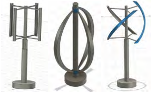
Figura 3. Turbina eólica tipo Darrieus, a) rotor con paletas curvas, b) rotor con paletas rectas, rotor con paletas helicoidales (Hernández, 2023).
