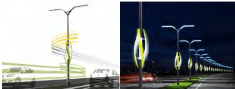
Figura 5. Sistemas eólicos impulsados por el viento generado por vehículos (Illuminet, 2023, https://illuminet.com/energia-eolica-de-autos-para-iluminar-carreteras/ ).
