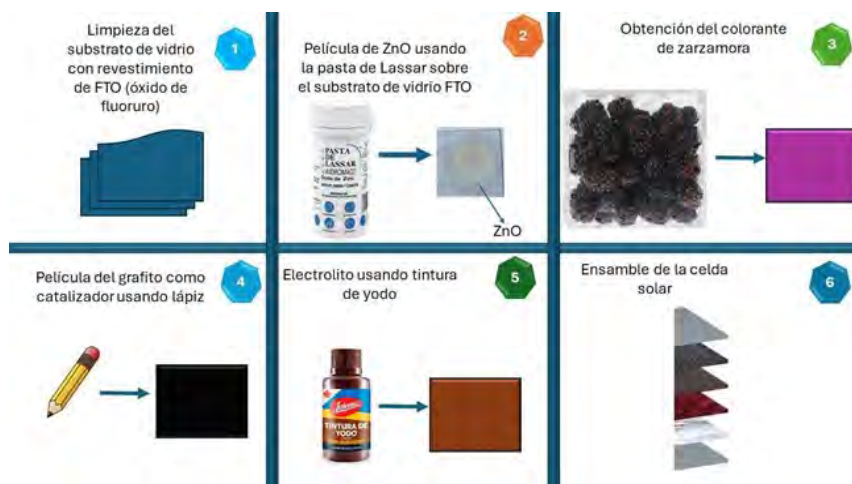
Figura 2. Materiales empleados para la fabricación de la celda solar sensibilizada por tinte. Elaboración propia.
