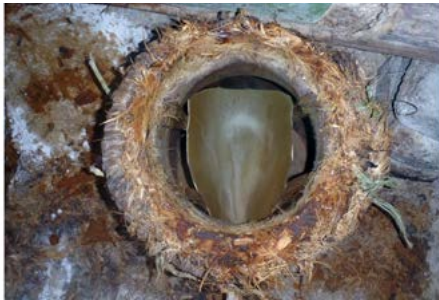
Figura 15. Detalle del trozo de penca de maguey que se coloca al interior del destilador que se utiliza como “cuchara” en donde cae el licor al condensarse los vapores de los mostos hervidos al contacto con el cazo.
