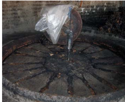
Figura 10. “Tahona” para moler los trozos de maguey cocido. Santiago Matatlán, Oaxaca. Fotografía: Víctor Hugo Romero Aranda.
